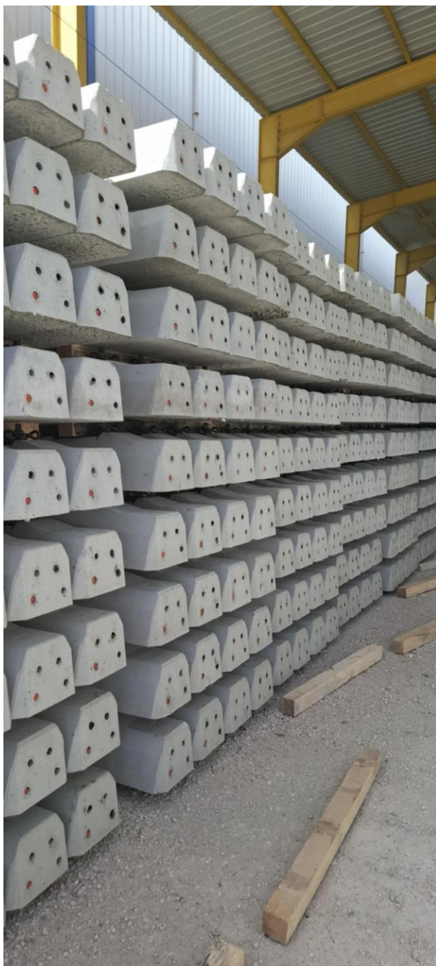
Φωτογραφία 2,3-Στρωτήρες με έλασμα και σήμανση
