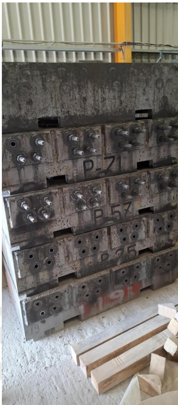
Φωτογραφία 1-Καλούπια Στρωτήρων
