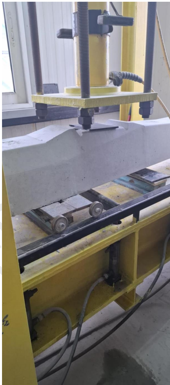
Φωτογραφία 5,6 – Δοκιμή 1) Αρνητικής ροπής κάμψης στο κέντρο του στρωτήρα και 2) Θετικής ροπής κάμψης στη θέση της τροχιάς
