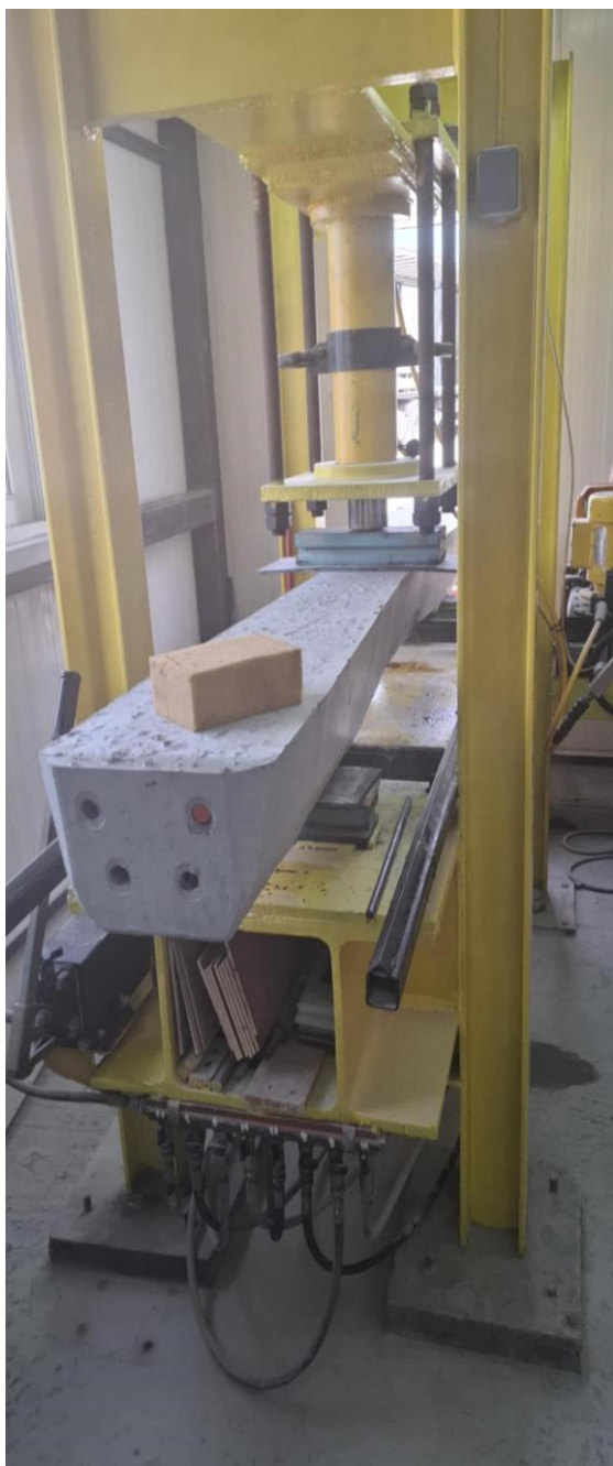
Φωτογραφία 5,6 – Δοκιμή 1) Αρνητικής ροπής κάμψης στο κέντρο του στρωτήρα και 2) Θετικής ροπής κάμψης στη θέση της τροχιάς
