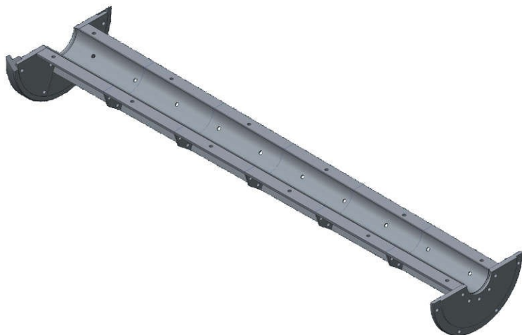
Σχ. 1. Μισό 3μετρο καλούπι (Εσωτερική όψη)
