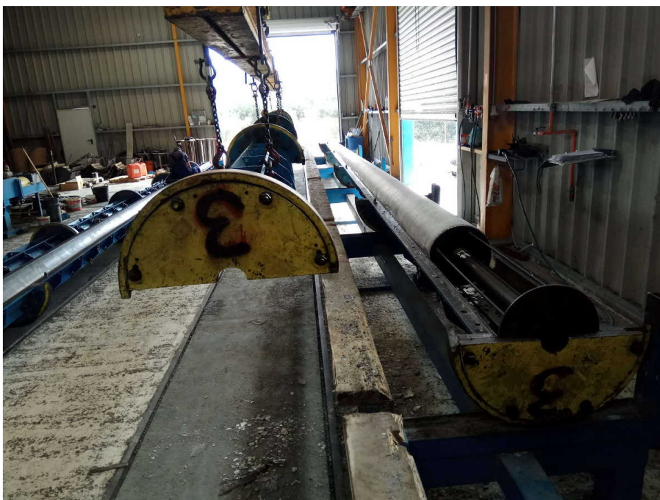
Φωτ. 2 Καλούπι στη θέση ξεκαλουπώματος. Χει απομακρυνθεί το πάνω μισό του καλουπιού και διακρίνεται η έτοιμη κολόνα
