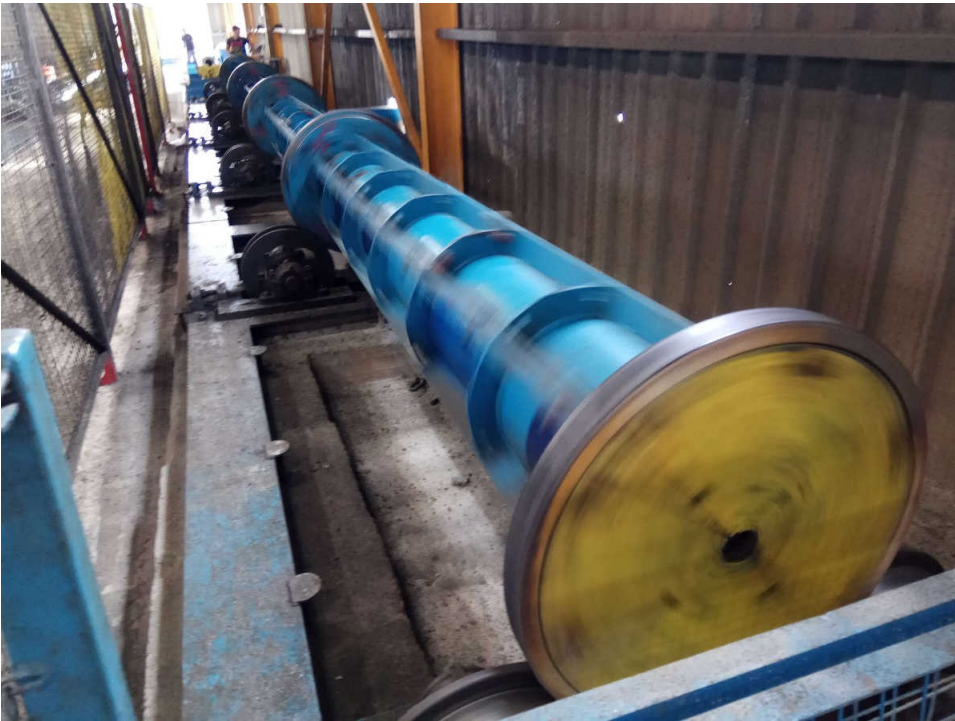
Φωτ. 3. Καλούπι σε θέση περιστροφής
